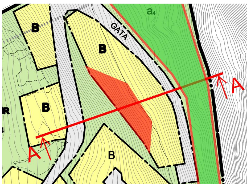
Figur 1. Beräkningssektion A, Rödmarkerat visar aktuell slänt
