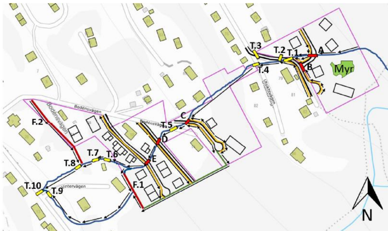
Figur 13. Lösningförslag för dagvattenhantering. Gula cylindrar: befintliga trummor numererade från 1 till 10; röda cylindrar: trummor som kommer behövas för att säkerställa bäckens rinnväg i och med planerade vägar, numererade från A till E; Mörkblå: bäcken som är ett biflöde till Kvambäcken; Orange: planerade vägdiken; mörkröda streck: rekommenderade fördröjningsdiken F.1 och F.2; grönt streck: avskärande dike som behövs för att få vattnet till fördröjningsdiken; svarta pilar visar rinnvägen; svarta fyrkanter illustrerar planerade huskroppar där ljusgröna fyrkanter illustrerar befintlig bebyggelse. Planområdet är markerat med lila.
