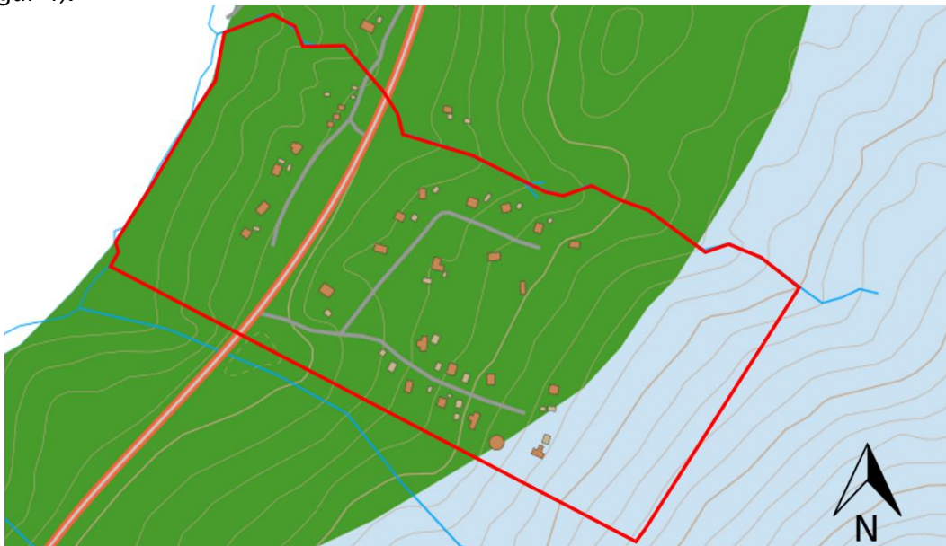
Figur 4. Jordarter (1:250 000 nordligaste Sverige) inom utredningsområdet (SGU, 2021). Grön: isälvsediment; ljusblå: morän. Ungefärlig gräns för utredningsområdet är markerad med röd linje.
