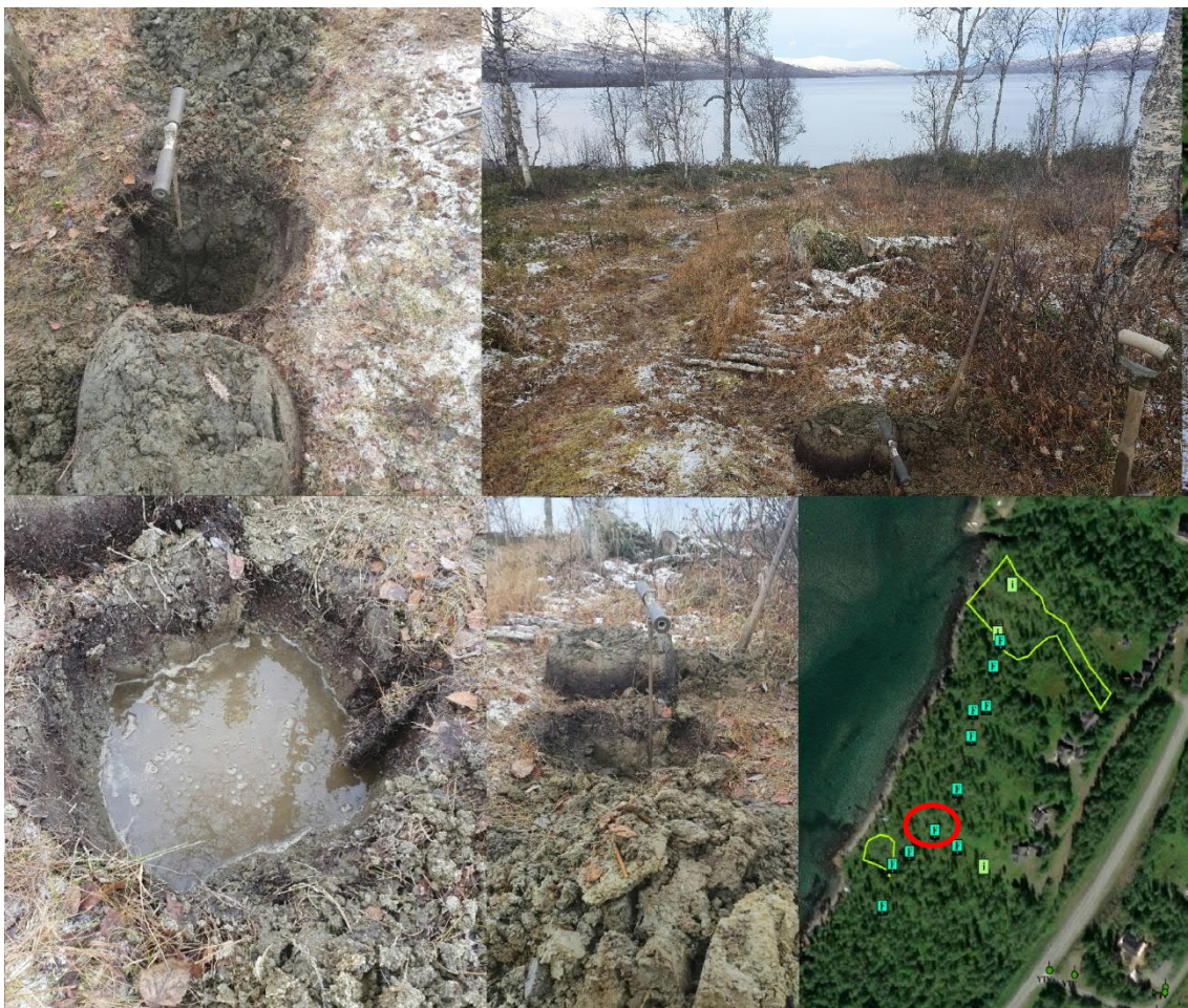
Figur 4. Handgrävd provgrop där humus påträffats ner till ca. 0,08 m under markytan över silt ner till ca. 0,7 m efterföljt av antagen morän. Grundvatten har påträffats ca. 0,2 m under markytan. Lokalisering av bilderna visas med röd cirkel [Platsbesök 211019].
