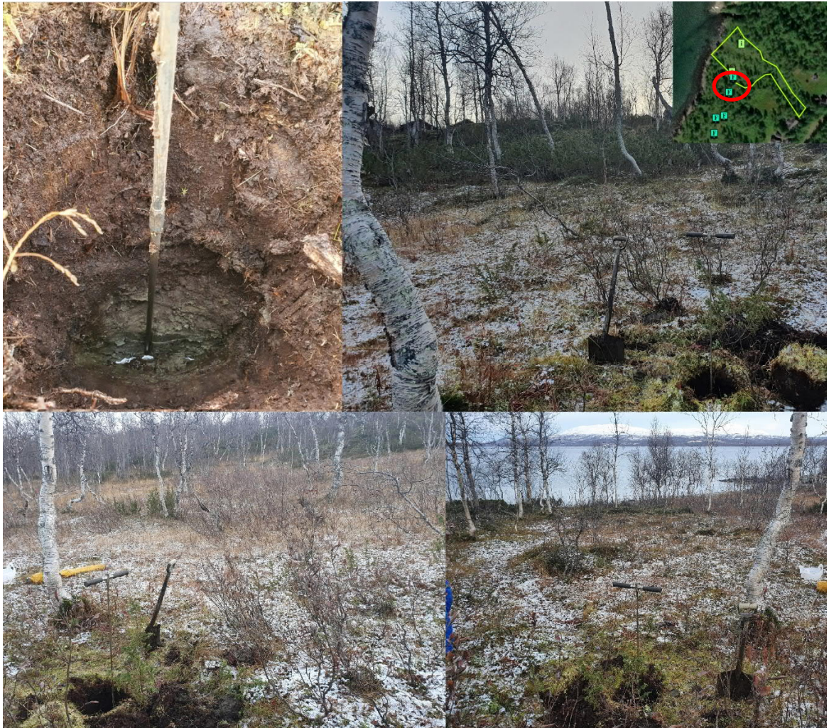
Figur 6. Handgrävd provgrop där torv ner till ca. 0,6 m under markyta över lerig silt ner till ca. 1,25 m efterföljt av antagen morän. Torvlagret antas variera mellan 0,4 och 1,0 m över myrområdet och djup till antagen morän antas variera mellan 0,4 och 1,6 m. Lokalisering av bilderna visas med röd cirkel [Platsbesök 211019].
