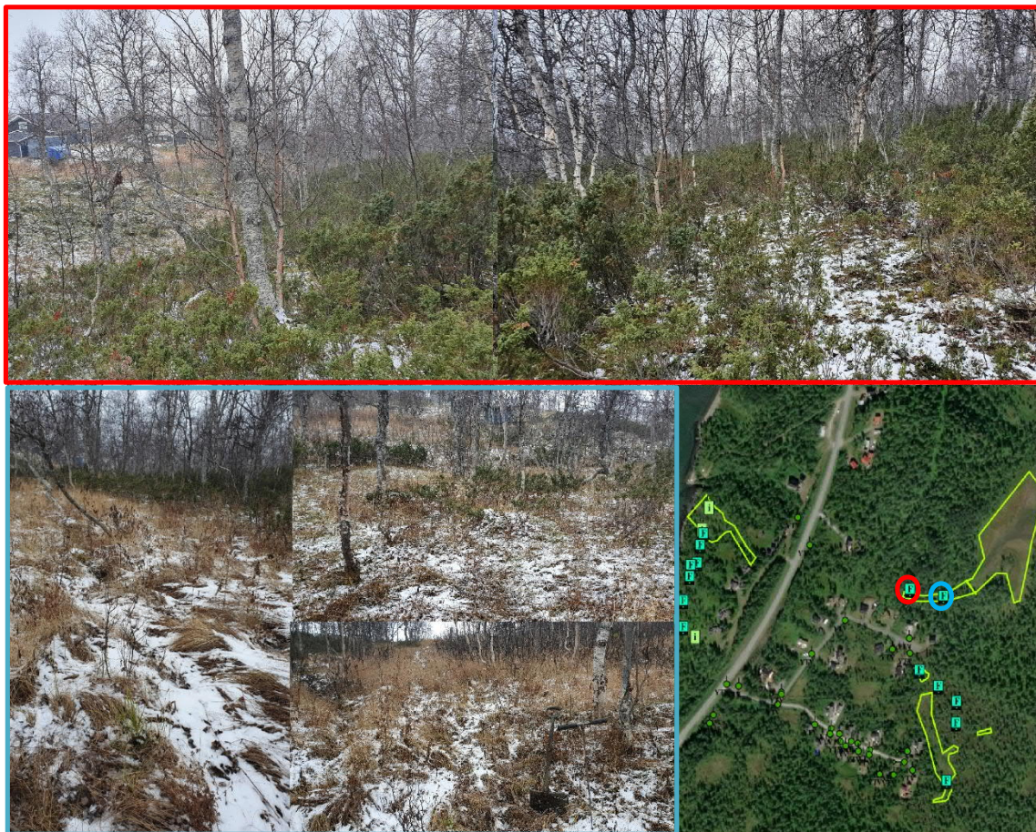
Figur 7. Sticksondering mellan ca. 0,3 och 1,0 m djupt torvlager påträffades över antagen morän. Området är omringat av skogsmark med block och myrområde. Lokalisering av bilderna visas med röd och blå cirkel där röd respektive blå rektangel tillhör färgen på cirkelarna. [Platsbesök 211019].
