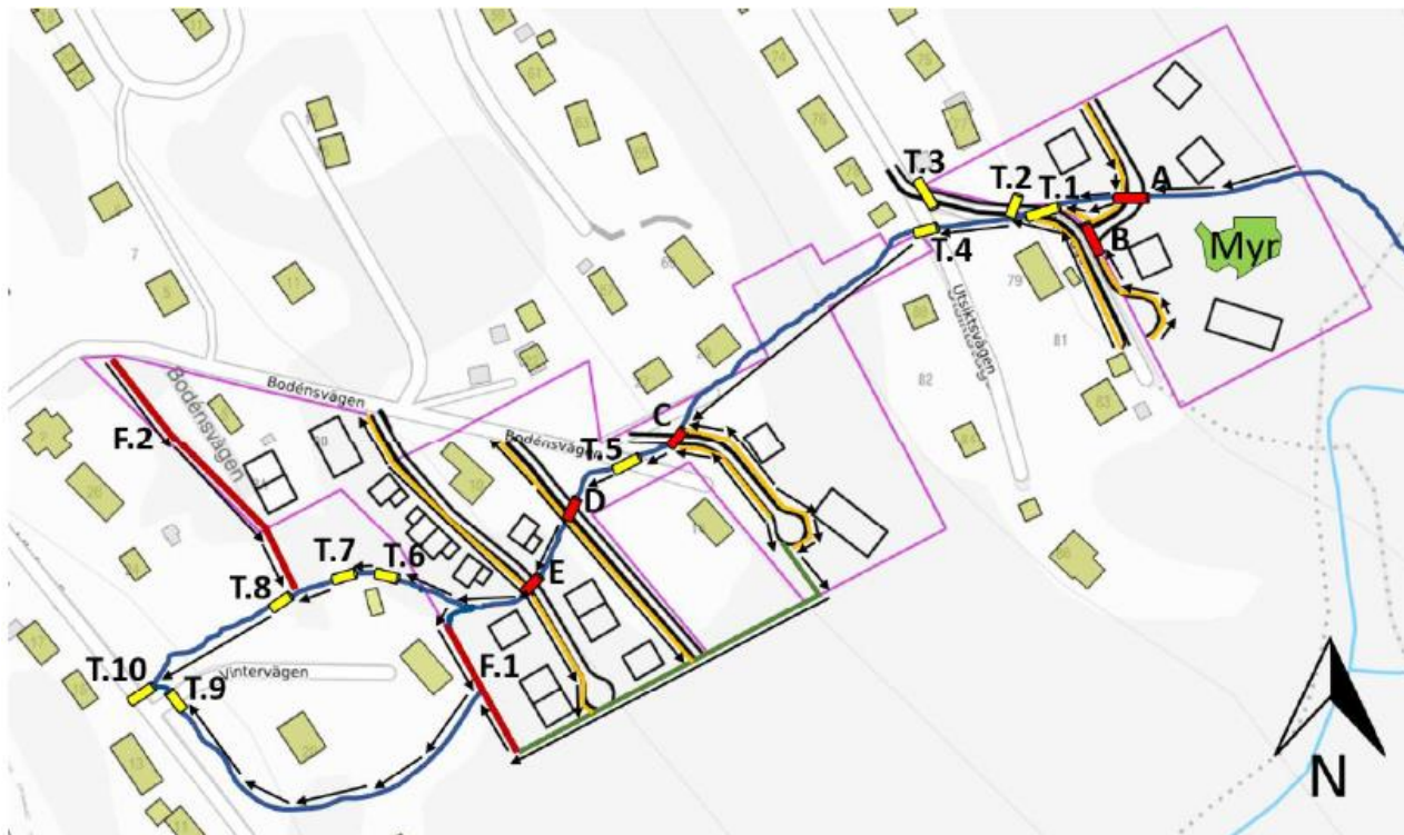
Figur 13. Lösningförslag för dagvattenhantering. Gula cylindrar: befintliga trummor numrerade från 1 till 10; röda cylindrar: trummor som kommer behövas för att säkerställa bäckens rinnväg i och med planerade vägar, numrerade från A till E; Mörkblå: bäcken som är ett biflöde till Kvambäcken; Orange: planerade vägdiken; mörkröda streck: rekommenderade fördröjningsdiken F.1 och F.2; grönt streck: avskärande dike som behövs för att få vattnet till fördröjningsdiken; svarta pilar visar rinnvägen; svarta fyrkanter illustrerar planerade huskroppar där ljusgröna fyrkanter illustrerar befintlig bebyggelse. Planområdet är markerat med lila.
