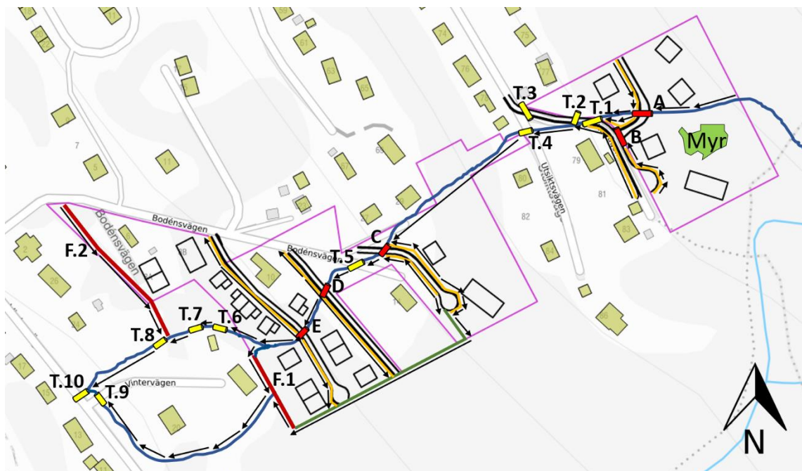
Figur 13. Lösningförslag för dagvattenhantering. Gula cylindrar: befintliga trummor numrerade från 1 till 10; röda cylindrar: trummor som kommer behövas för att säkerställa bäckens rinnväg i och med planerade vägar, numrerade från A till E; Mörkblå: bäcken som är ett biflöde till Kvarnbäcken; Orange: planerade vägdiken; mörkröda streck: rekommenderade fördröjningsdiken F.1 och F.2; grönt streck: avskärande dike som behövs för att få vattnet till fördröjningsdiken; svarta pilar visar rinnvägen; svarta fyrkanter illustrerar planerade huskroppar där ljusgröna fyrkanter illustrerar befintlig bebyggelse. Planområdet är markerat med lila.
