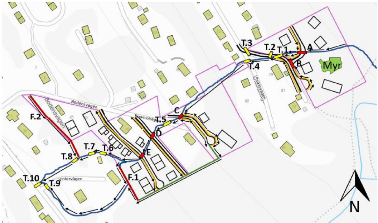
Figur 13. Lösningförslag för dagvattenhantering. Gula cylindrar: befintliga trummor numererade från 1 till 10; röda cylindrar: trummor som kommer behövas för att säkerställa bäckens rinnväg i och med planerade vägar, numererade från A till E; Mörkblå: bäcken som är ett biflöde till Kvambäcken; Orange: planerade vägdiken; mörkröda streck: rekommenderade fördröjningsdiken F.1 och F.2; grönt streck: avskärande dike som behövs för att få vattnet till fördröjningsdiken; svarta pilar visar rinnvägen; svarta fyrkanter illustrerar planerade huskroppar där ljusgröna fyrkanter illustrerar befintlig bebyggelse. Planområdet är markerat med lila.
