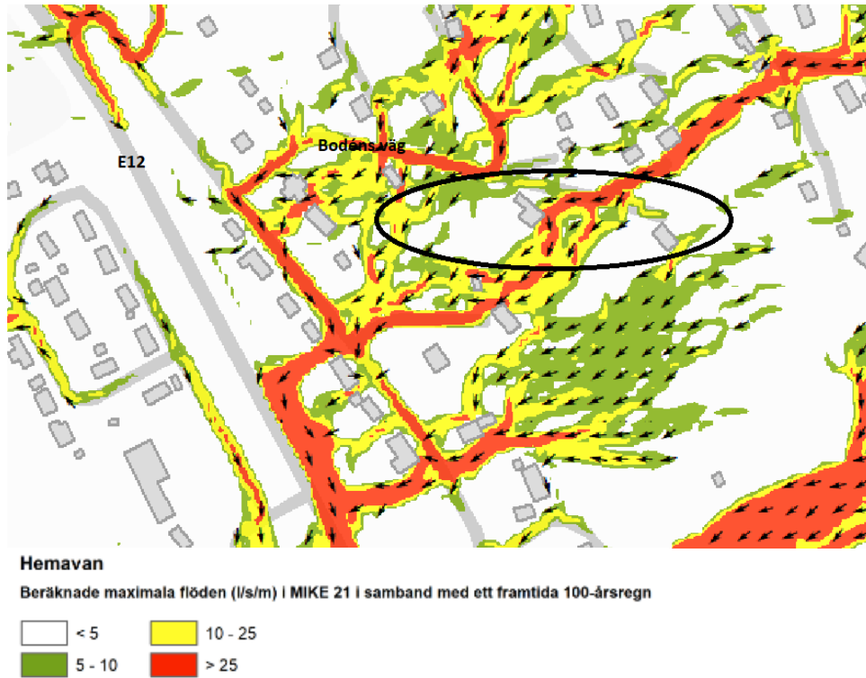
Bild 15. Utdrag från skyfallskarteringen med flödesriktning vid maximala markvattenflöden (l/s/m) där aktuellt planområde markeras ungefärligt med svart ring.
