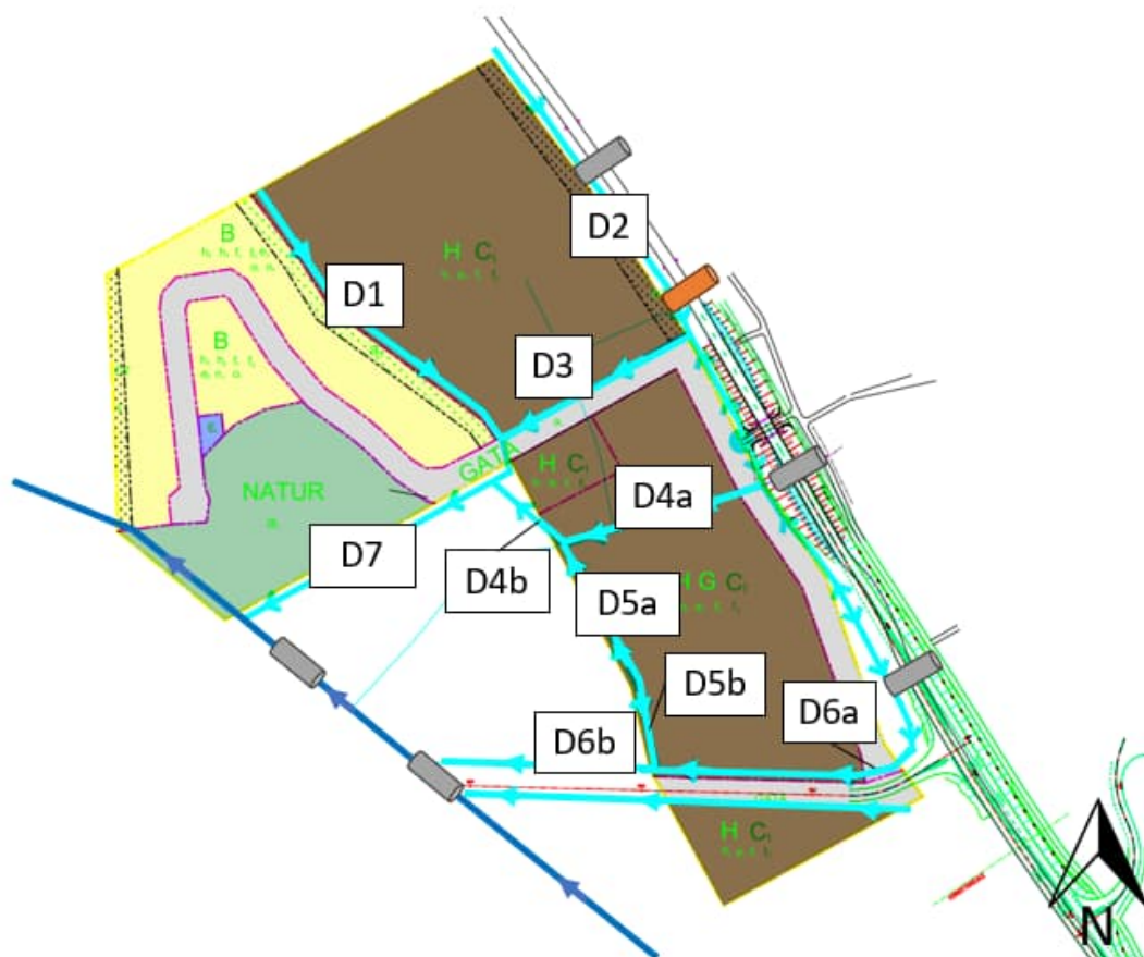
Figur 16. Lokalisering av de dikessektioner som behöver kunna hantera vatten från planområdet samt inkommande dagvatten från uppströms belägna områden. Även avskärande dike (D1) som skyddar bostadsområdet från avrinnande dagvatten från handelsområdet redovisas.
