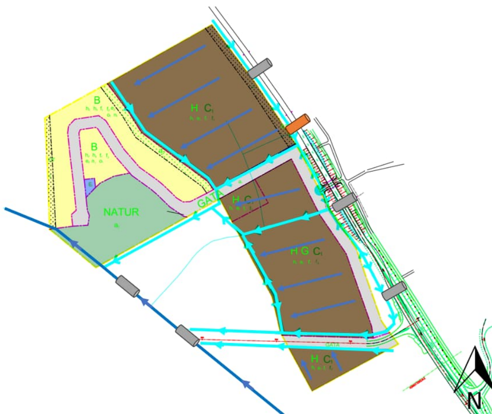
Figur 15. Föreslagen dagvattenhantering för planområdet. Flöden från uppströms belägna avrinningsområden föreslås ledas längs med och genom planområdet via öppna diken (turkosa pilar). Befintliga vägtrummor visas i grått och föreslagna ny trumma visas i orange. Ytlig avrinning från handelsområdet visas med mellanblå smala pilar. Inkommande flöde/vattendrag i planrådets södra del redovisas med mörkblå pilar.
