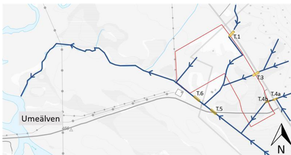
Figur 9. Rinnpilar visar ytavrinning kring och genom planområdet (Tyréns Sverige AB, 2023a).
