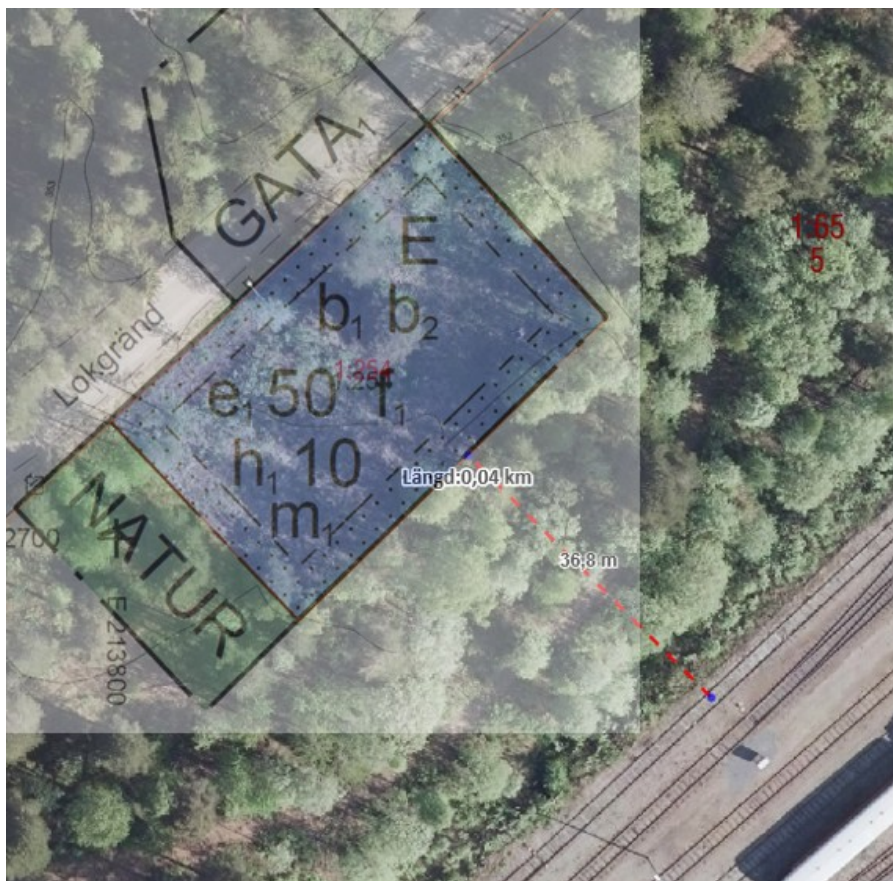
Figur 127: Bilden visar mått från närmaste spår (mitt) fram till plangräns, ca 37 meter.
