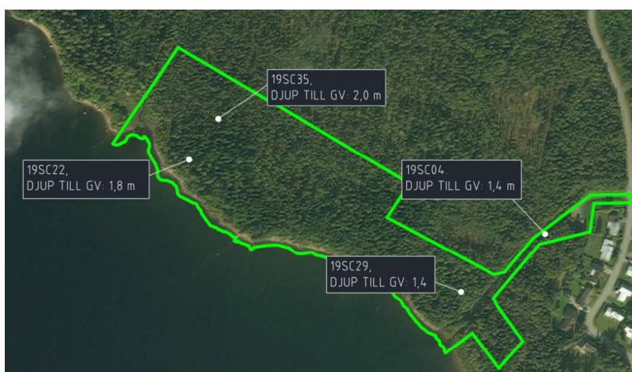
Figur 7. Undersökningspunkter med grundvattenrör
