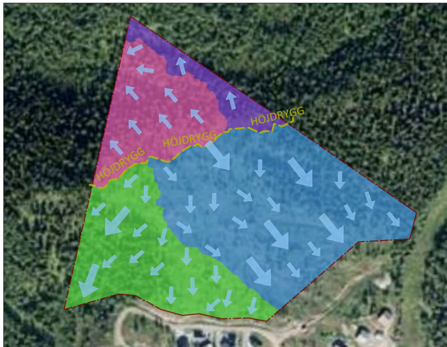
Figur 4. Planområdet har delats in i fyra avrinningsområden med avseende på befintlig ytavrinning. Rosa och lila områden har nordlig riktning. Blått och grönt område har sydlig riktning.
