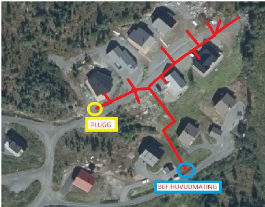
Bild 5. Röd linje avser ungefärlig placering av befintlig vattenledning till fastigheter på Rävstigen
