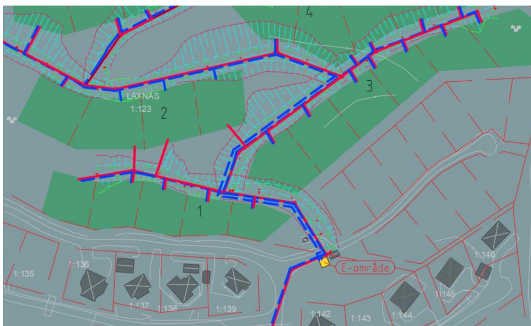
Figur 3. Placering teknikhus med tryckstegring och brandpost. E-område.
