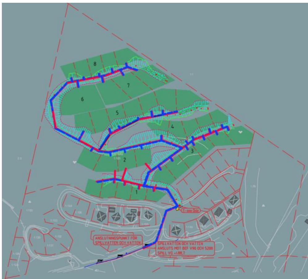
Figur 4. Översikt planområde. Blå linje- Vattenledning. Röd linje – Spilledning. Gröna fält avser delområden för byggrätt. Tomtindelning är schematisk
