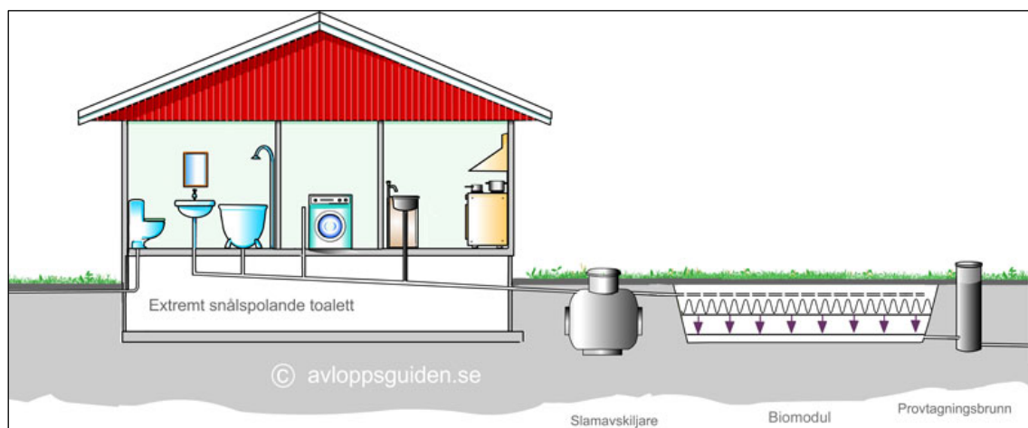
Figur 15. Illustration av Biomodul. (Bild hämtad från avloppsguiden.se)
