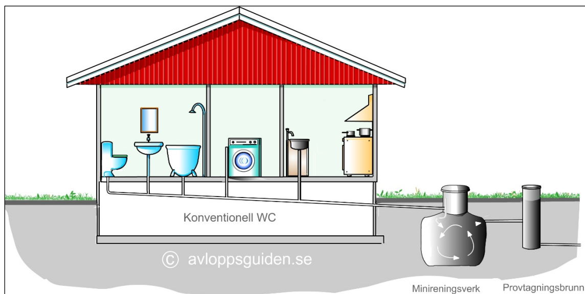
Figur 16 Illustration av Minireningsverk. (Bild hämtad från avloppsguiden.se)
